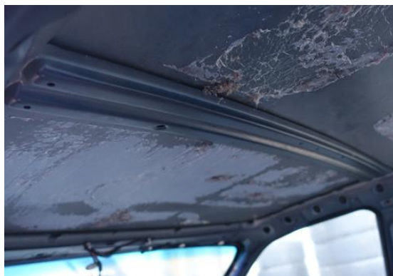
Ilustracja 9: Belka wzmacniająca dach
