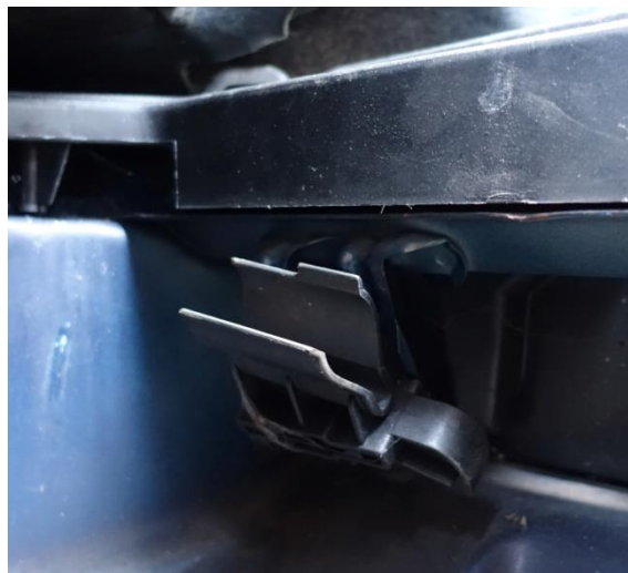
Ilustracja 8: Mocowanie lewarka zmiany koła zapasowego
