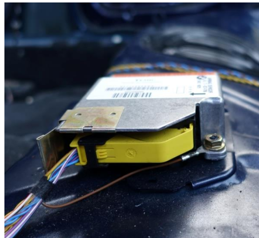
Ilustracja 6: Moduł elektroniczny wraz z podstawką
