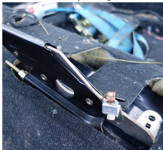
Ilustracja 9: Dźwignia hamulca ręcznego wraz z mocowaniem
