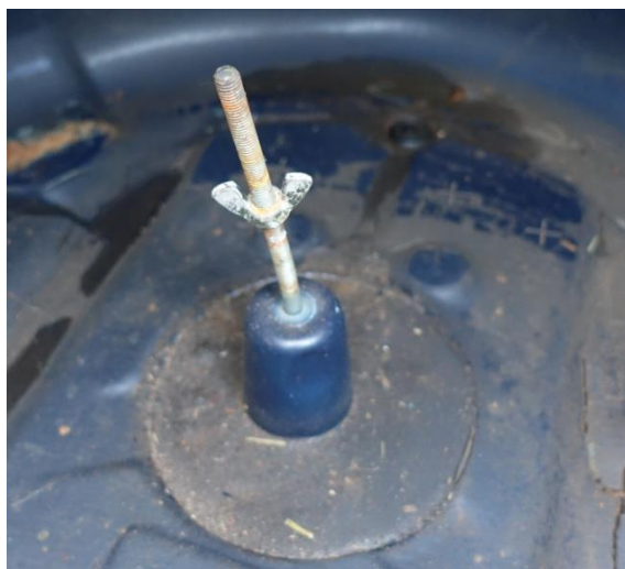
Ilustracja 7: Mocowanie koła zapasowego wraz z podstawą
